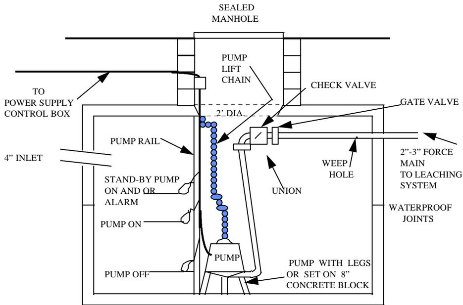
Figure 30-1 - Effluent Pump Chamber
